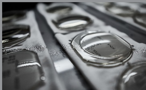
Lentilles imprimées en 3D par Luxexcel
